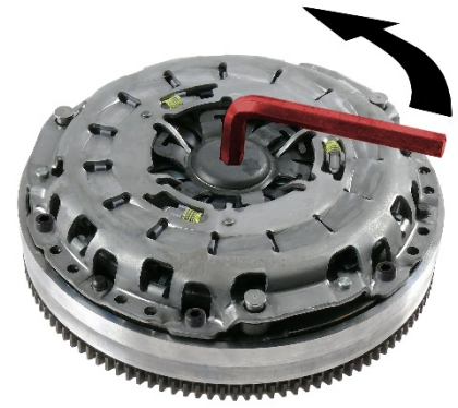
Abb. / Fig 3: Verriegelungsstück herausdrehen Unscrew locking piece Retirer la pièce de verrouillage en tournant Desenroscar la pieza de enclavamiento Rimozione dell'elemento di bloccaggio
