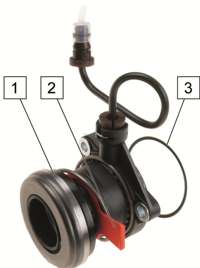
Fig. 1 Центральная муфта сцепления / Centralny wyprzęgnik / Centrální vypínač / Centrálny vysúvač / Dispozitiv central de debreiere / Централен изключател / Kinyomócsapágy / Centralna naprava za izklapljanje / Centrālā sajūga uzmaiva / Isetsentreeruv siduri lahtusmuhv
